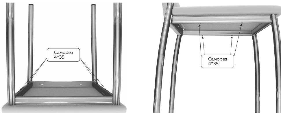
**5** Поставить стул на ровную поверхность, проверив правильность сборки избегая перекосов и неравномерностей примыкания деталей затянуть крепёжные винты и гайку
